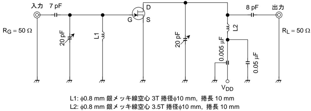
図 1 100 MHz 電力利得および雑音指数測定回路
